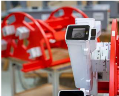
AVES High Precision Counter zur präzisen Zählung von Schwärmen und einzelnen Vögeln an Offshore-Windenergieanlagen
