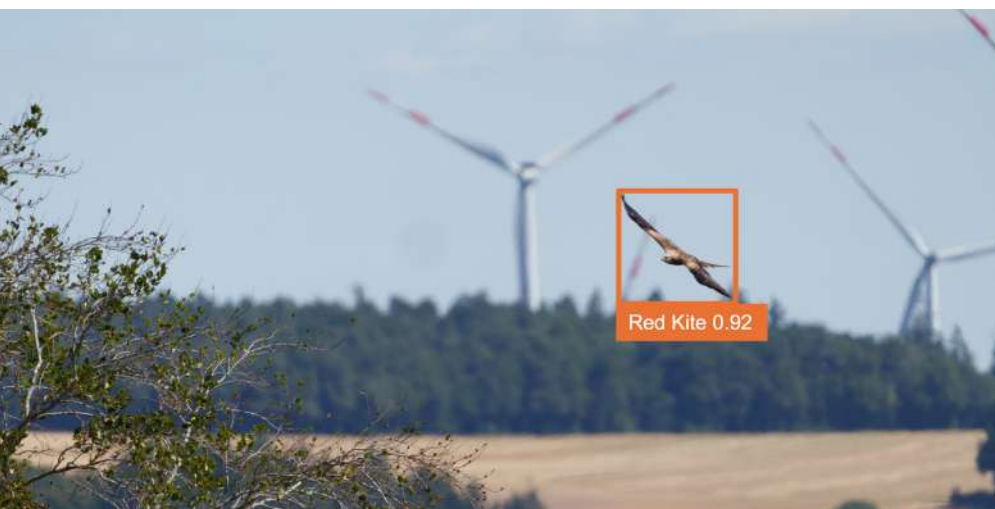
AVES Wind Antikollisionssystem: Darstellung der Vogeldetektion durch AVES Wind mit Artenkennungs-KI unter Angabe der Wahrscheinlichkeit
