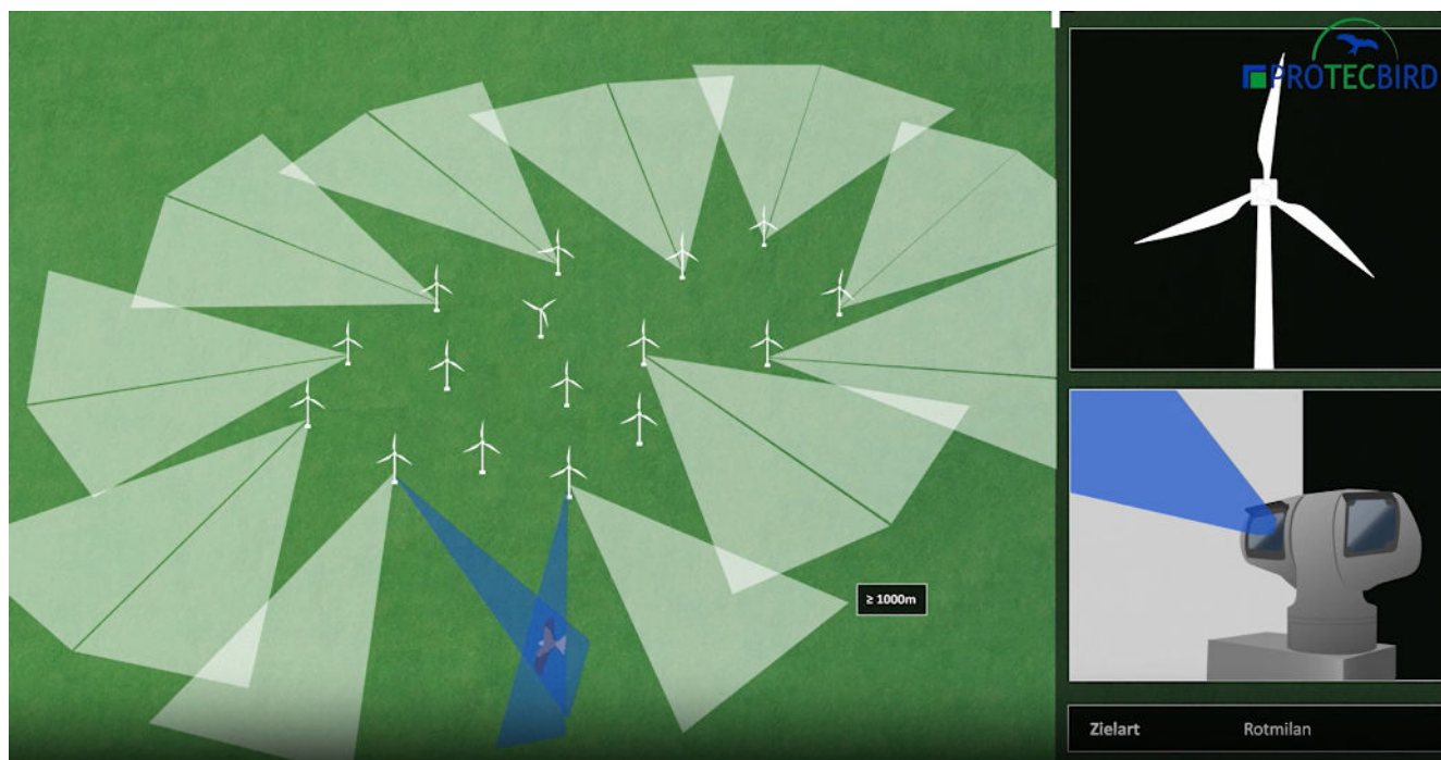
Abbildung 4 Positionsbestimmung über Triangulation von mind. 2 AVES-AKS
