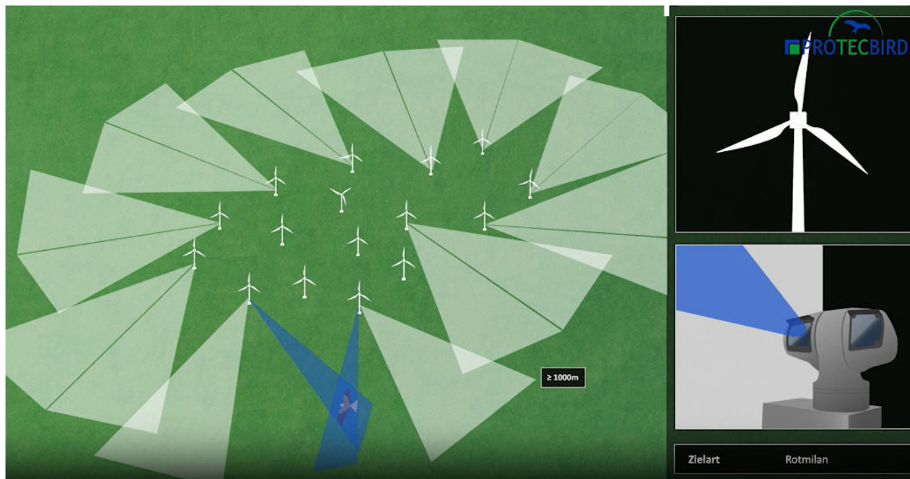
Abbildung 4 Positionsbestimmung über Triangulation von mind. 2 AVES-AKS
